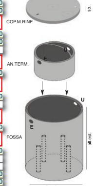
**ANELLO SEDIMENTATORE APPOGGIATO SU 4** SOSTEGNI IN TEFLON AVVITATI SUL FONDO
